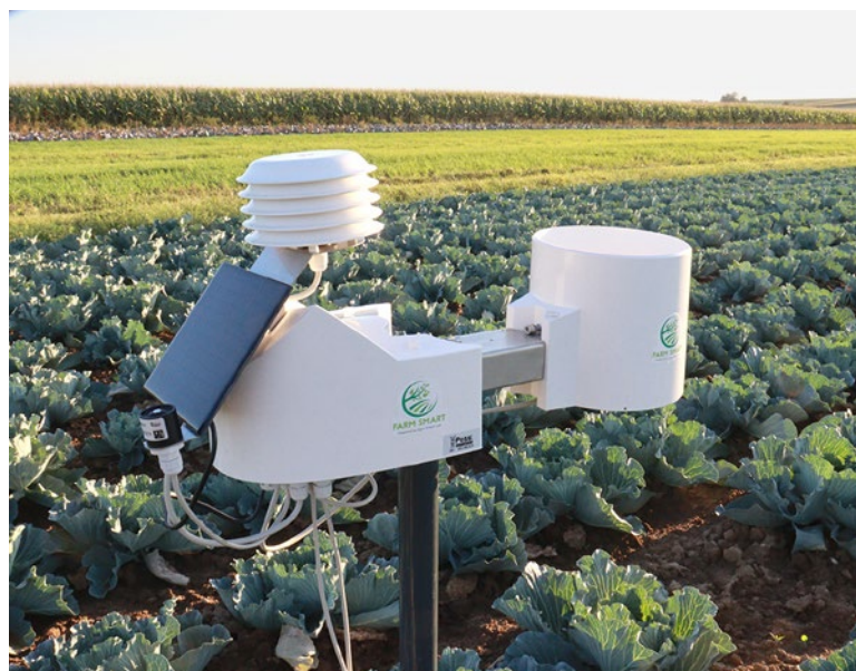
Fot. 1. Stacja meteorologiczna Metos firmy Pessl zainstalowana w gospodarstwie objętym systemem monitoringu zagrożeń chorobami i szkodnikami Farm Smart
