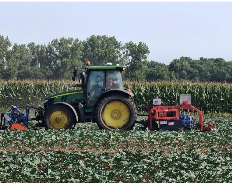
Fot. 3. Zestaw pielników pracujący w uprawie brokułów – z przodu aktywna glebogryzarka, z tyłu pielnik Ferrari, który niszczy również chwasty pomiędzy roślinami w rzędzie
