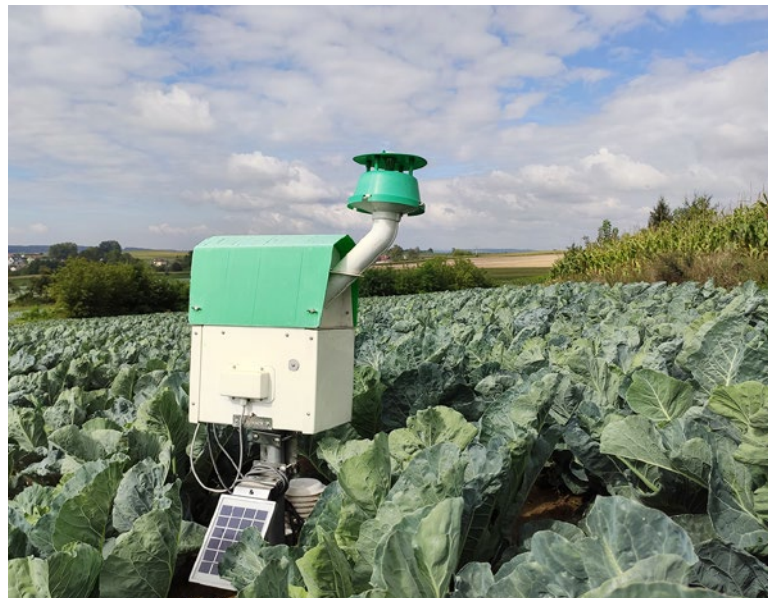
Fot. 2. Pułapka feromonowa zainstalowana w uprawie kalafiora
