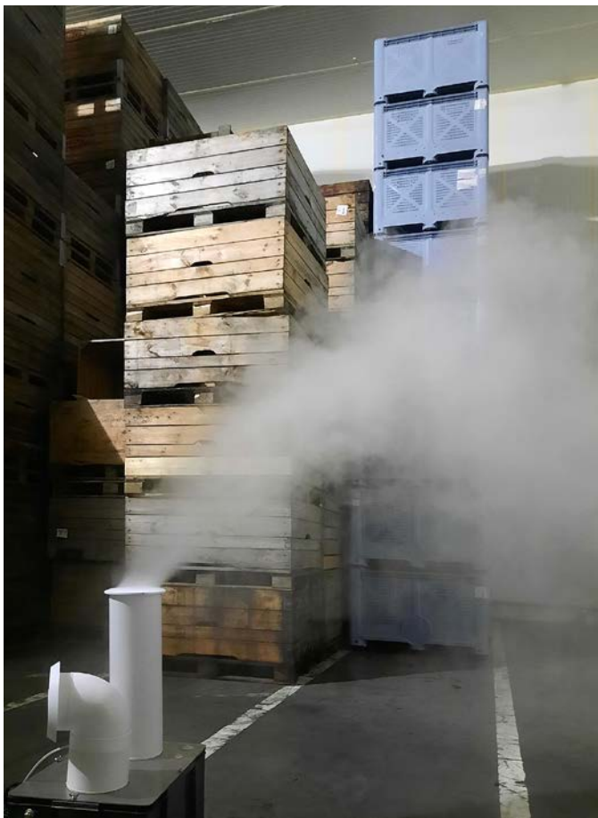
Fot. 2. Technologia zamgławiania suchą mgłą przy wykorzystaniu urządzenia ultradźwiękowego
