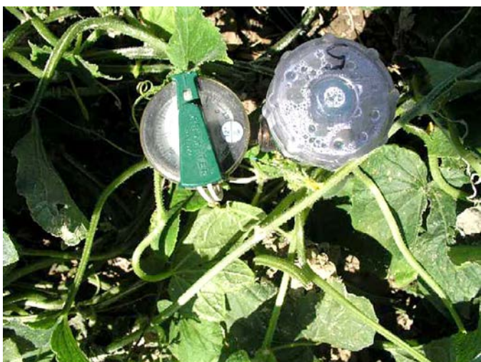
Fot. 3. Urządzenia do automatycznego włączania i wyłączania systemów nawadniających
