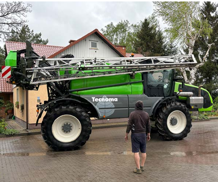
Fot. 7. Wykorzystywany w gospodarstwie opryskiwacz samojezdny marki Tecnomat
